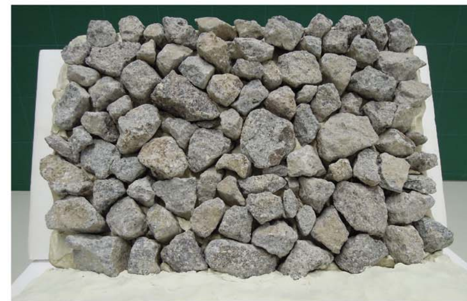
○石積みの良い積み方例 ⇒縦横に“目”が通っておらず、石と石がきちんとかみ合った石積み
