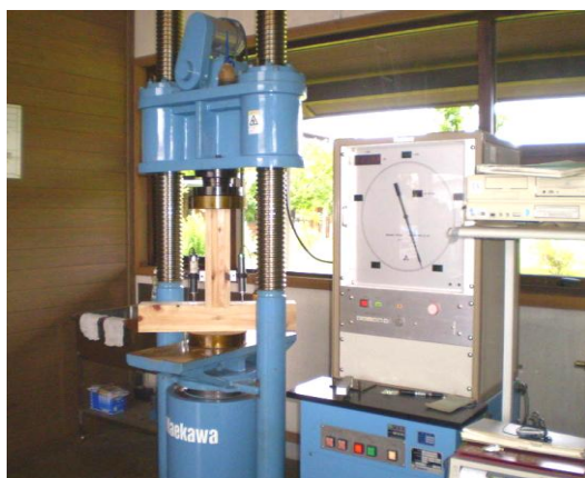
柱と土台のめり込み試験
