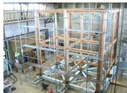
軸組構造体の水平加力試験
