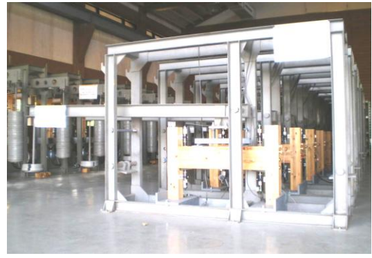
柱と梁の接合部クリープ試験
