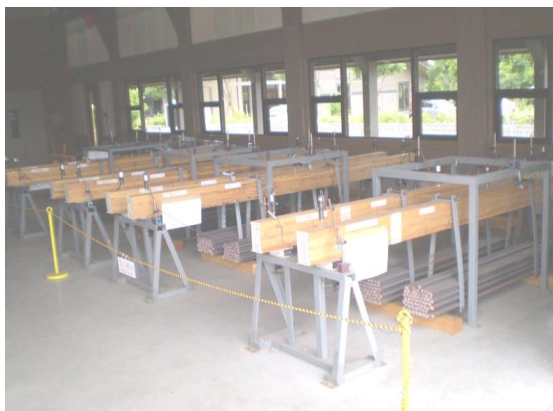
スギ材およびベイマツ材のクリープ試験
