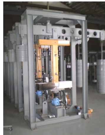
柱脚柱頭接合部クリープ試験
