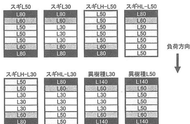
図1 集成材のラミナ構成
