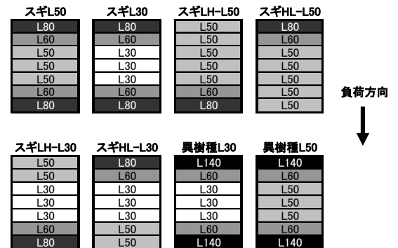
図2 集成材(梁部分)のラミナ構成
