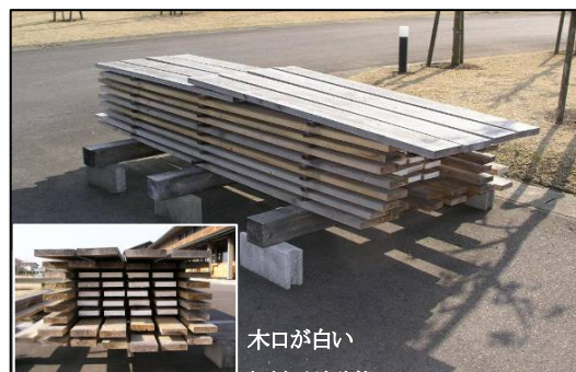
図3 天然乾燥試験体 積みみ状況
