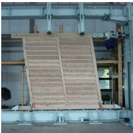
写真1 横貼り壁試験状況
