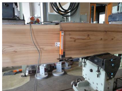
写真2 せん断破壊の状況
