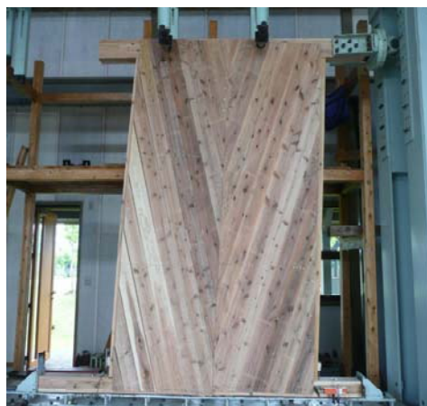
写真2 斜貼り壁試験状況
