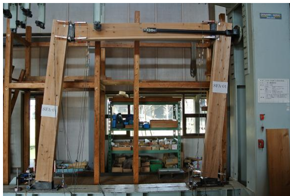
写真2 試験体の終局状態
