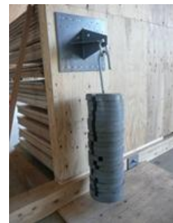
写真1 吊り荷重試験
