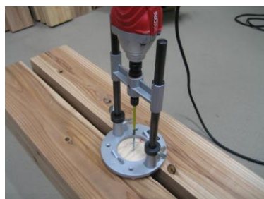
図2 ガイドを用いたねじの打ち込み
