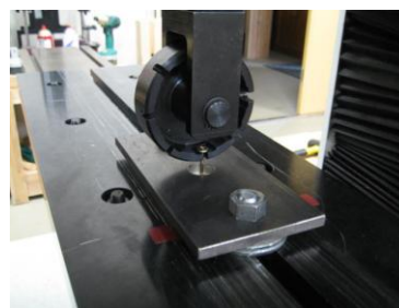
図3 引抜試験の様子
