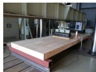
写真3 パネル曲げ試験
