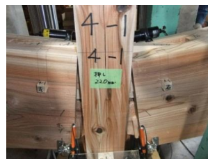
図4 押し方向加力の一例
