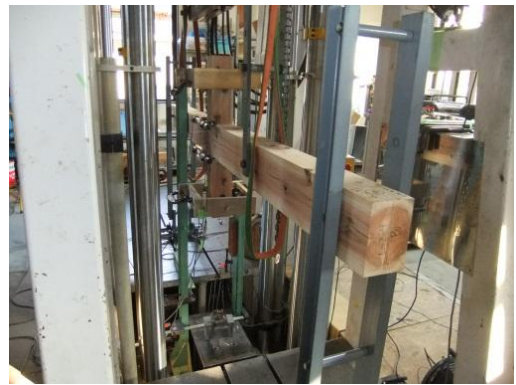
図2 試験方法(対称純曲げ試験)
