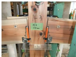
図3 引き方向加力の一例
