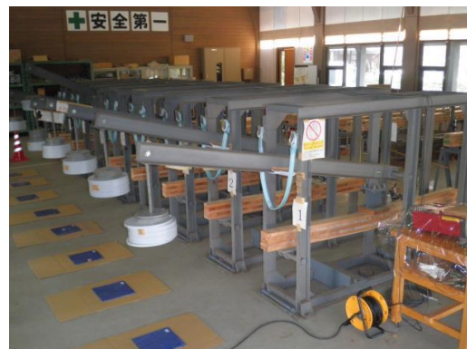
図 1 クリープ関数試験の状況
