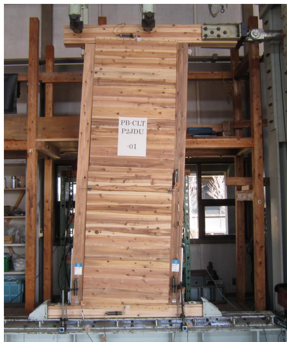
図2 CP2JDU試験体の終局状態
