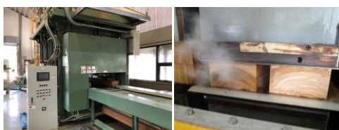
写真 1 ホットプレス（左）と表面処理状況（右）
