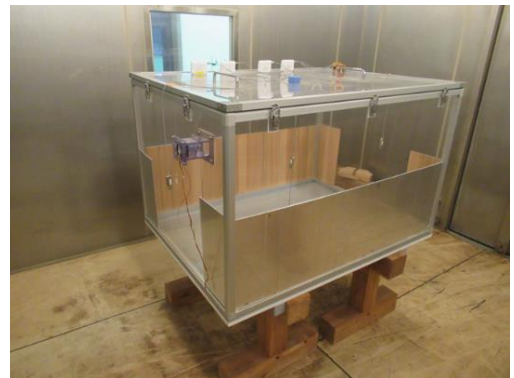
図1 アクリルボックス試験(気積率 1.5)
