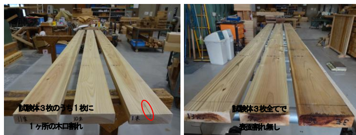
図 1 45mm 厚 乾燥終了後の表面（左：105℃-40h 右：105℃-52h）
