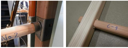
(a) 金具接合 (b) 木組み接合
