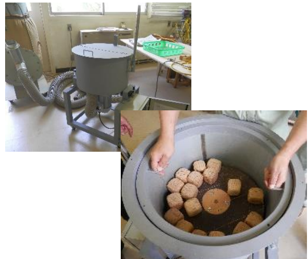
図6 木球製造装置
