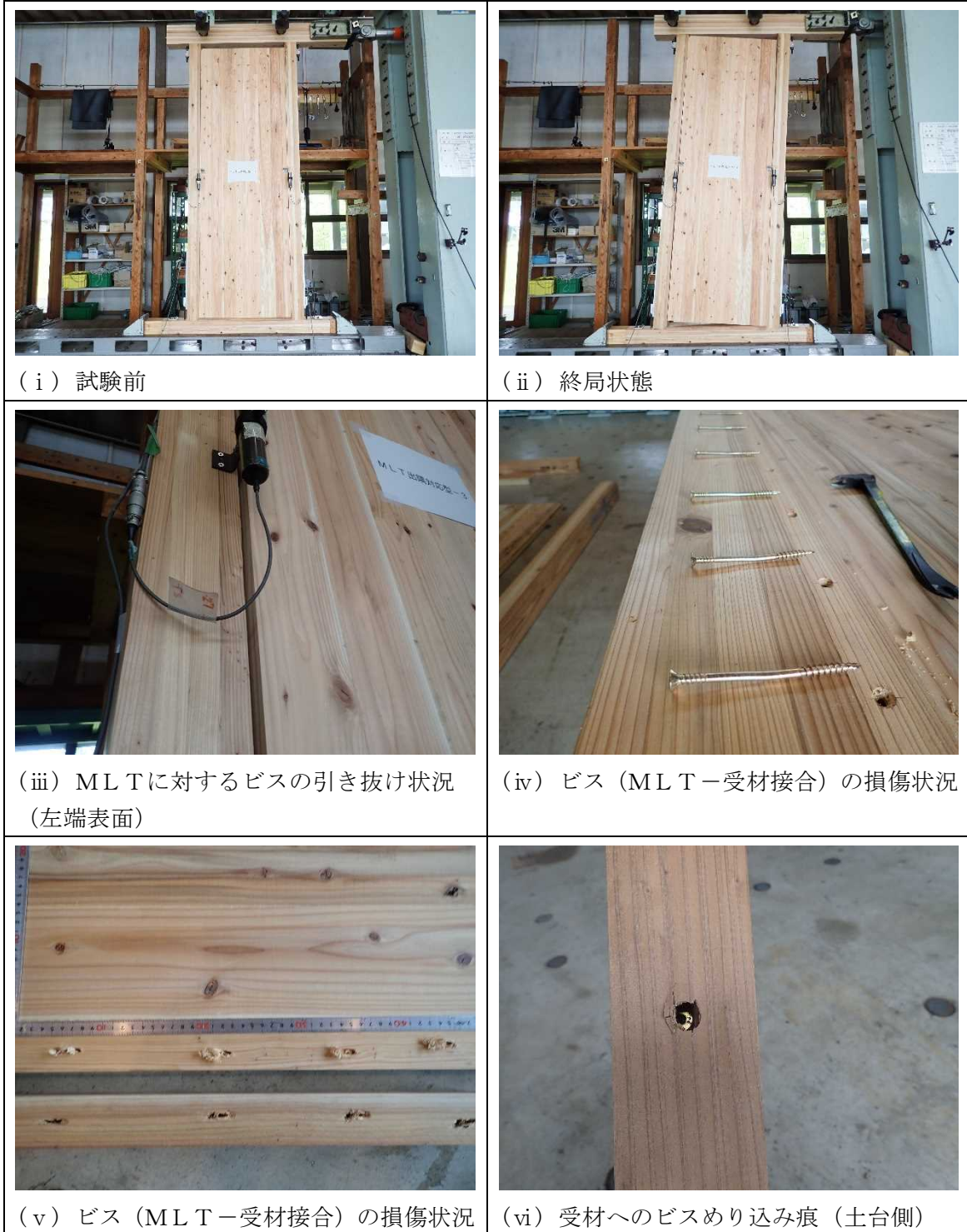
写真3 出隅対応型－3 試験体の破壊性状
