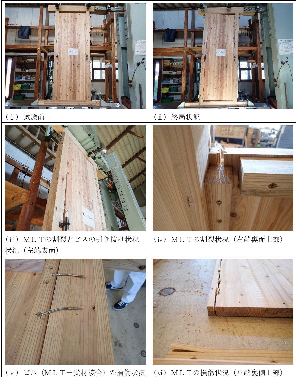
写真3 標準型－3 試験体の破壊性状
