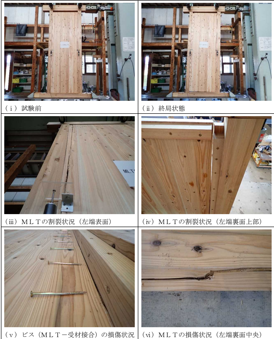
写真2 標準型－2 試験体の破壊性状
