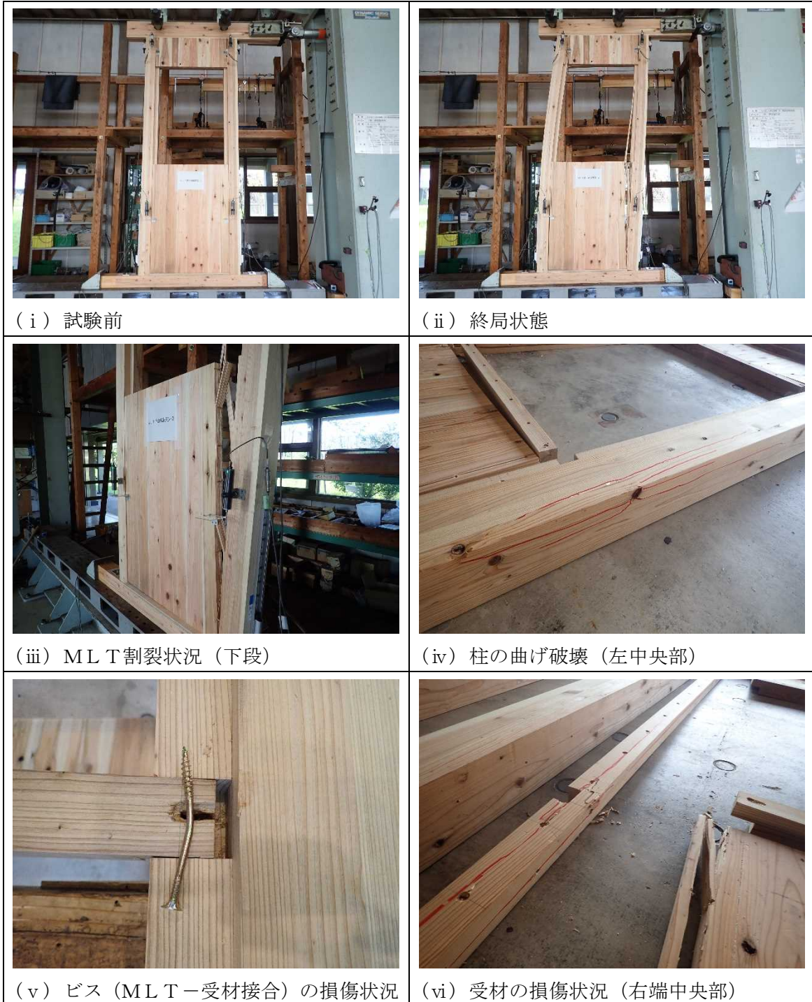
写真3 開口部設置型－3 試験体の破壊性状
