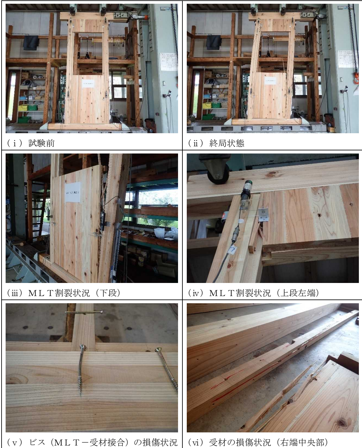
写真2 開口部設置型－2 試験体の破壊性状
