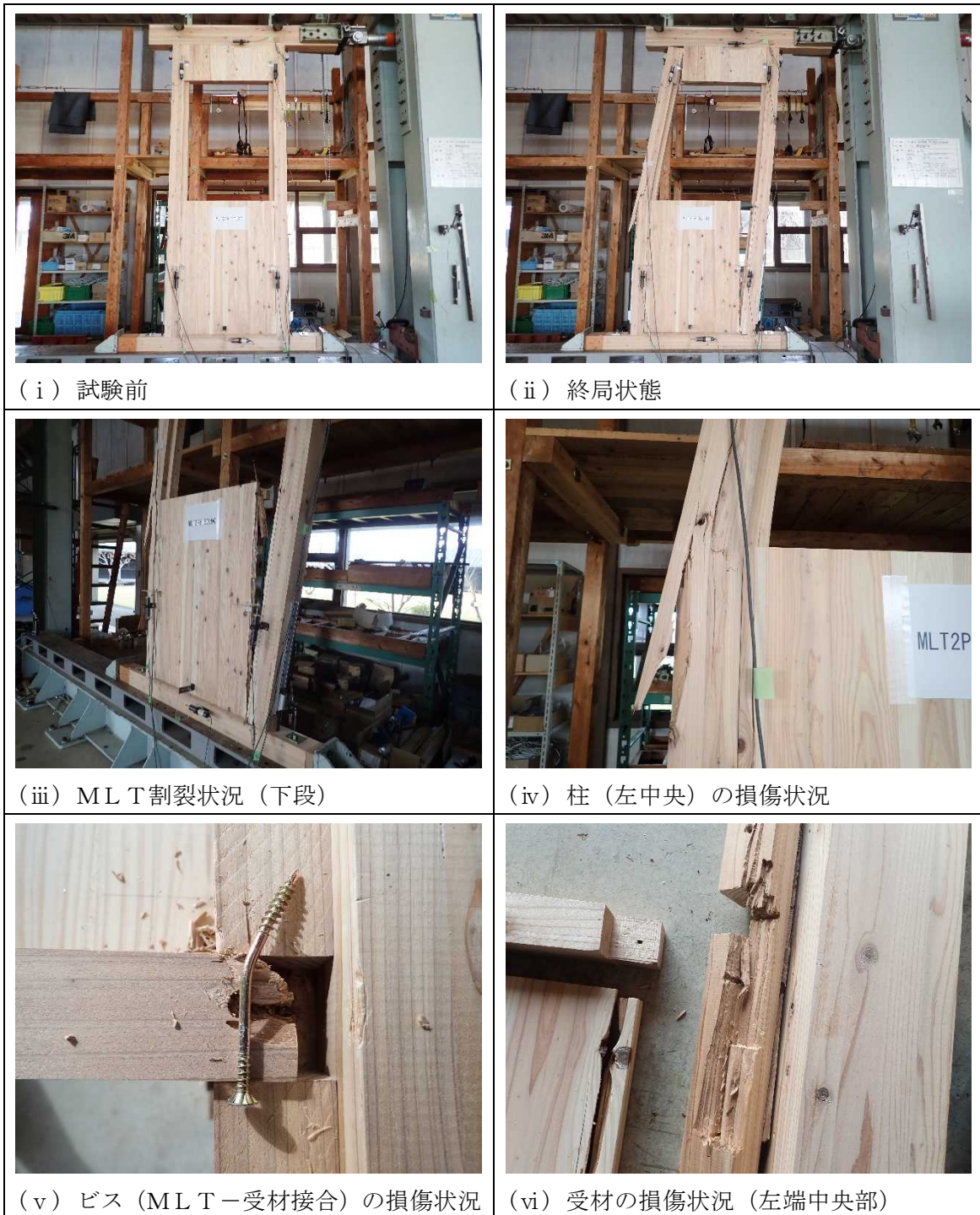
写真1 開口部設置型－1 試験体の破壊性状
