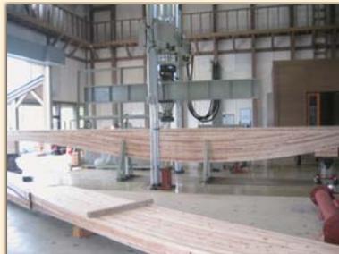
写真 2 実大曲げ試験の様子
