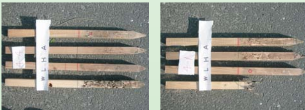
写真2 シロアリ食害判定時の杭の様子
