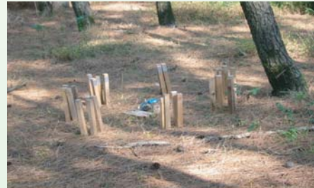
写真1 シロアリ試験杭の設置状況
