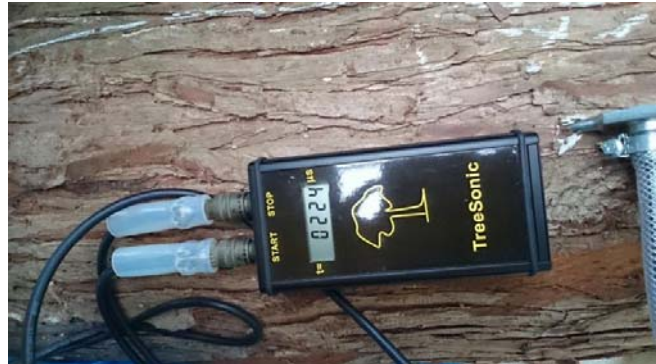
写真-2 応力波伝播速度測定
