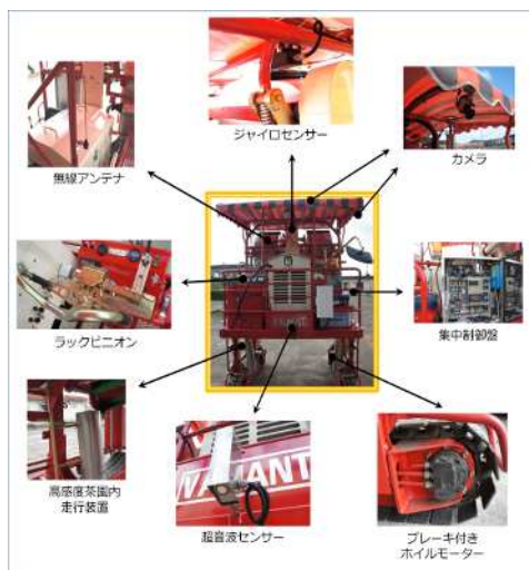
図1 無人茶摘採機の制御装置
