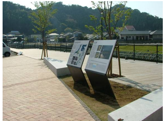
形状を工夫し、盤面の高さを抑制することで、眺望の確保に配慮した例（日南市）
