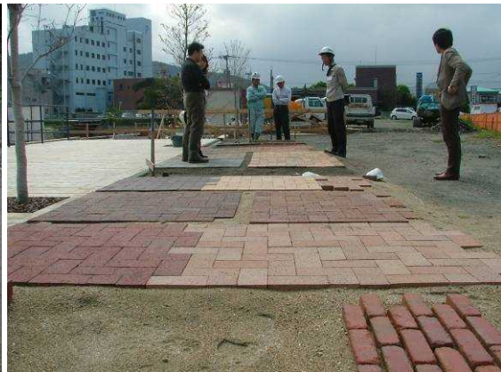
舗装材を敷設し、劣化状況等を確認している様子 (日南市)
