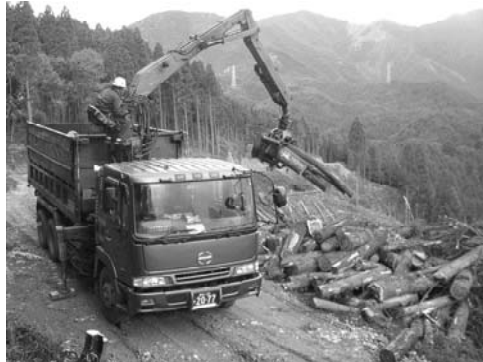
林地残材積込・運搬状況
