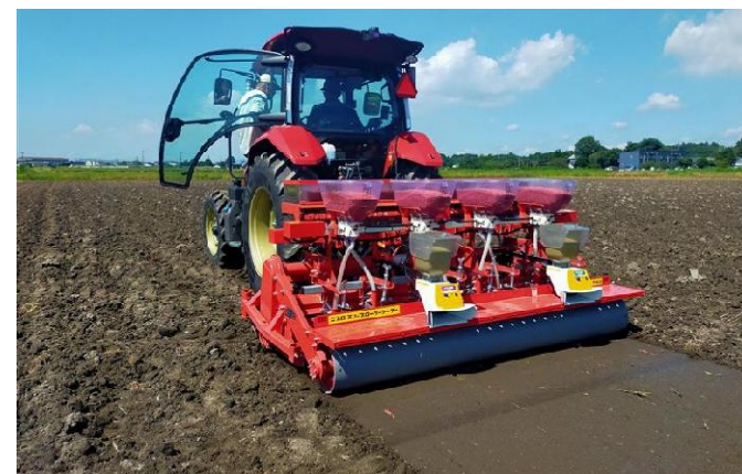
大豆のスリップローラーシーダー(施肥・播種・鎮圧)の実証
