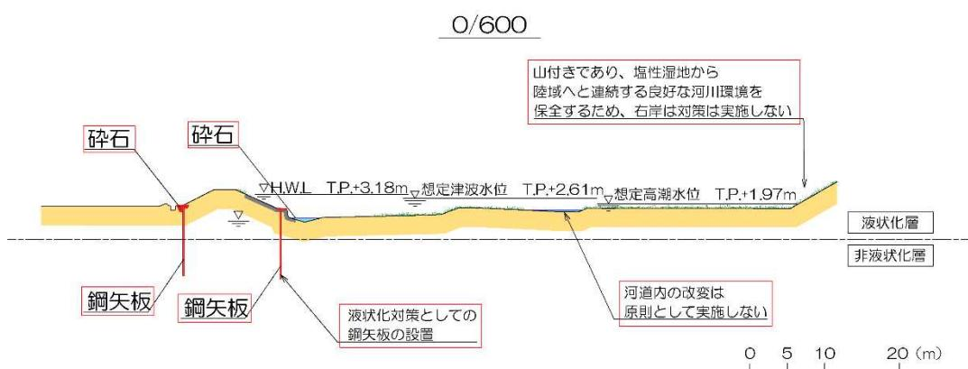
図 5-2 熊野江川河道改修断面図
