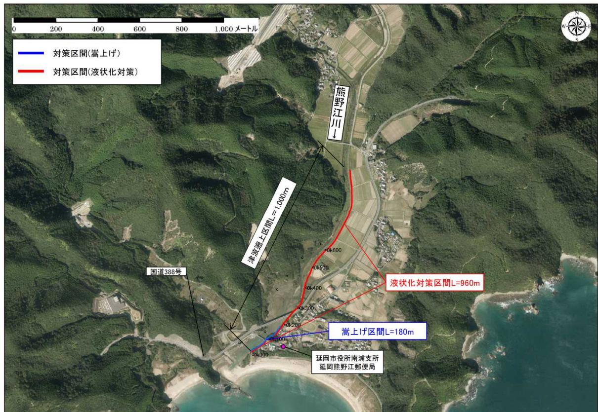
図 5-1 熊野江川施工区間図
