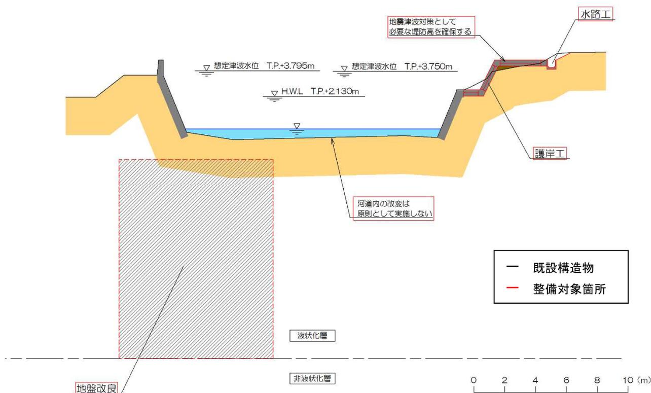
図 4-2 伊比井川河道改修断面図
