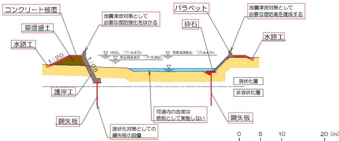
図 5-2 風田川河道改修断面図
