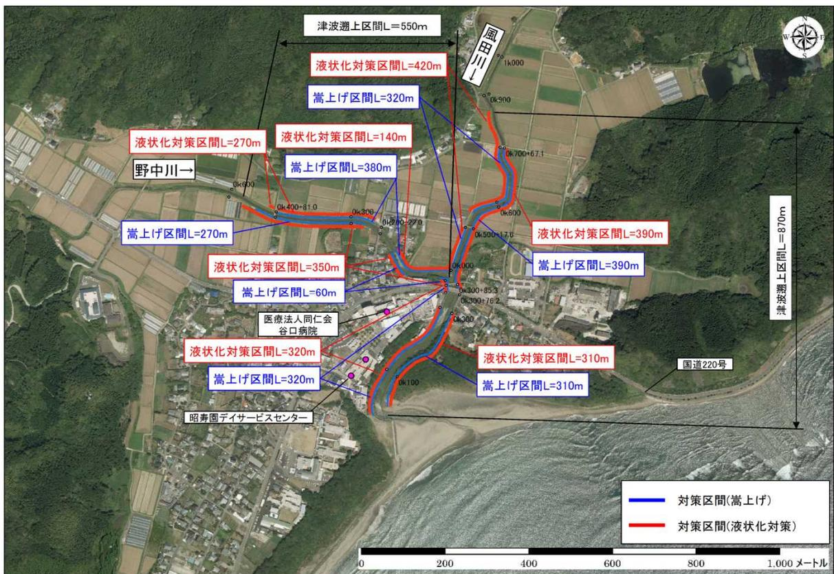
図 5-1 風田川施工区間図
