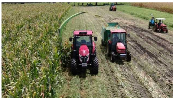
図5.無人機によるトウモロコシ刈取と 有人機による梱包作業
