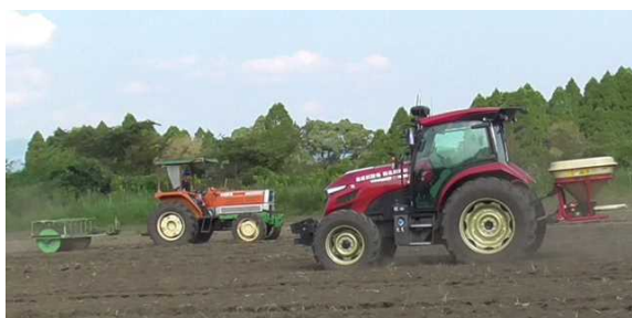
図1.無人機の播種（ブロードキャスター） と有人機の鎮圧作業
