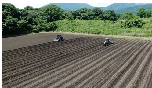
図2.無人機（ジェットシーダー） の播種と有人機の鎮圧作業
