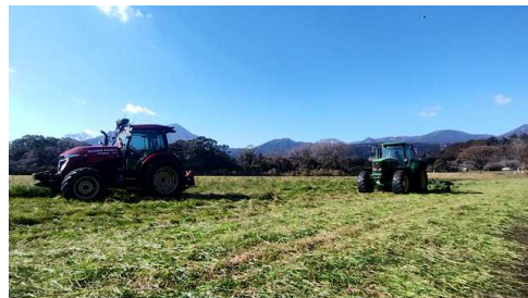
図4.無人機による牧草刈取と有人機 による反転作業
