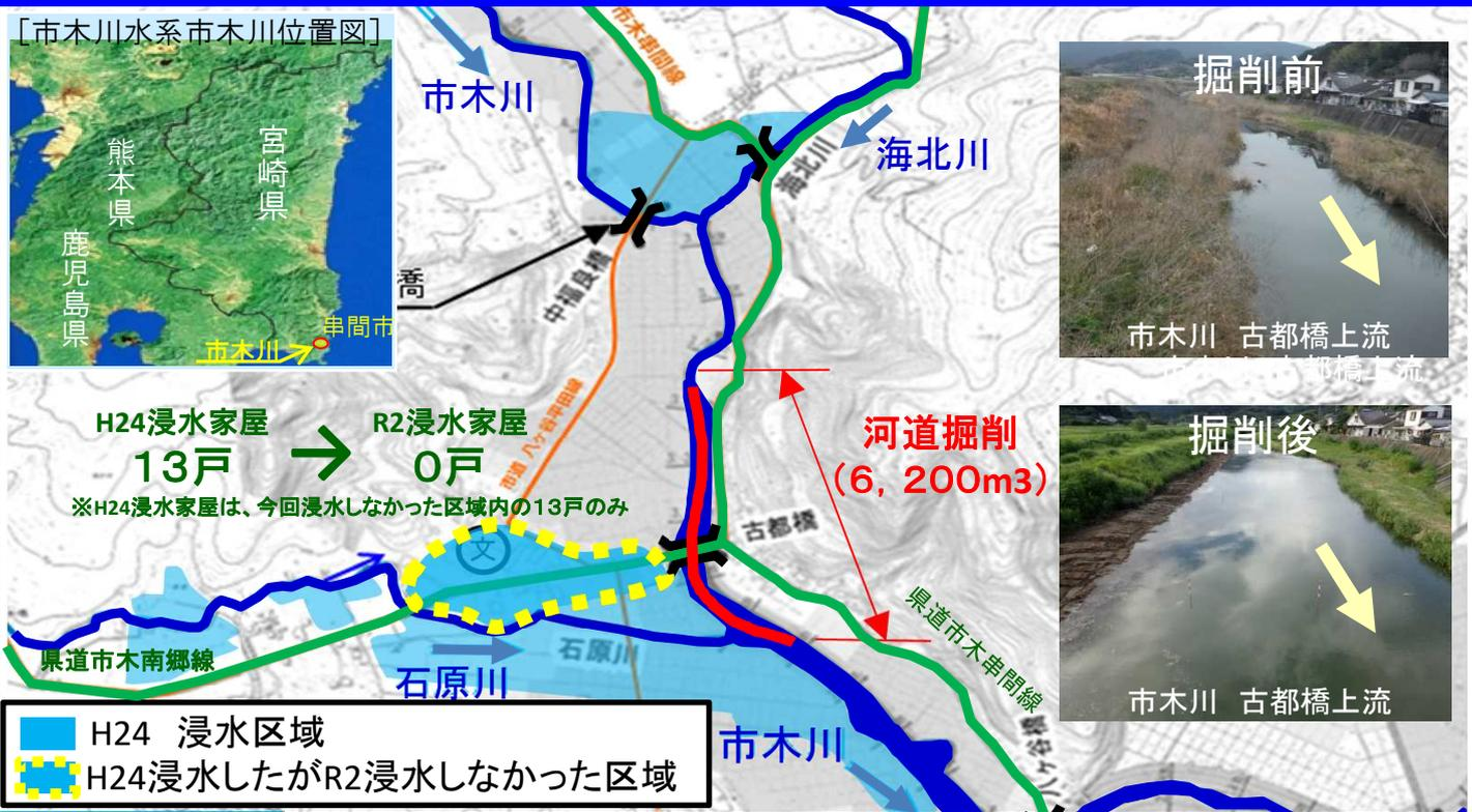
**整備効果** 河道掘削により家屋の浸水戸数が **13戸 → 0戸** 被害を**解消!!**
