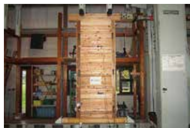
耐力壁強度試験
