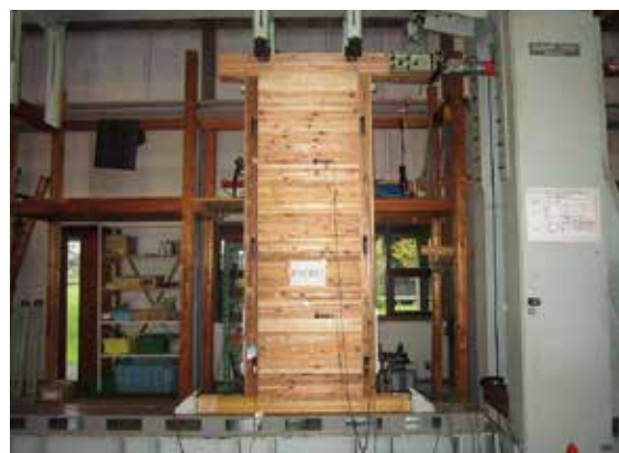
耐力壁強度試験
