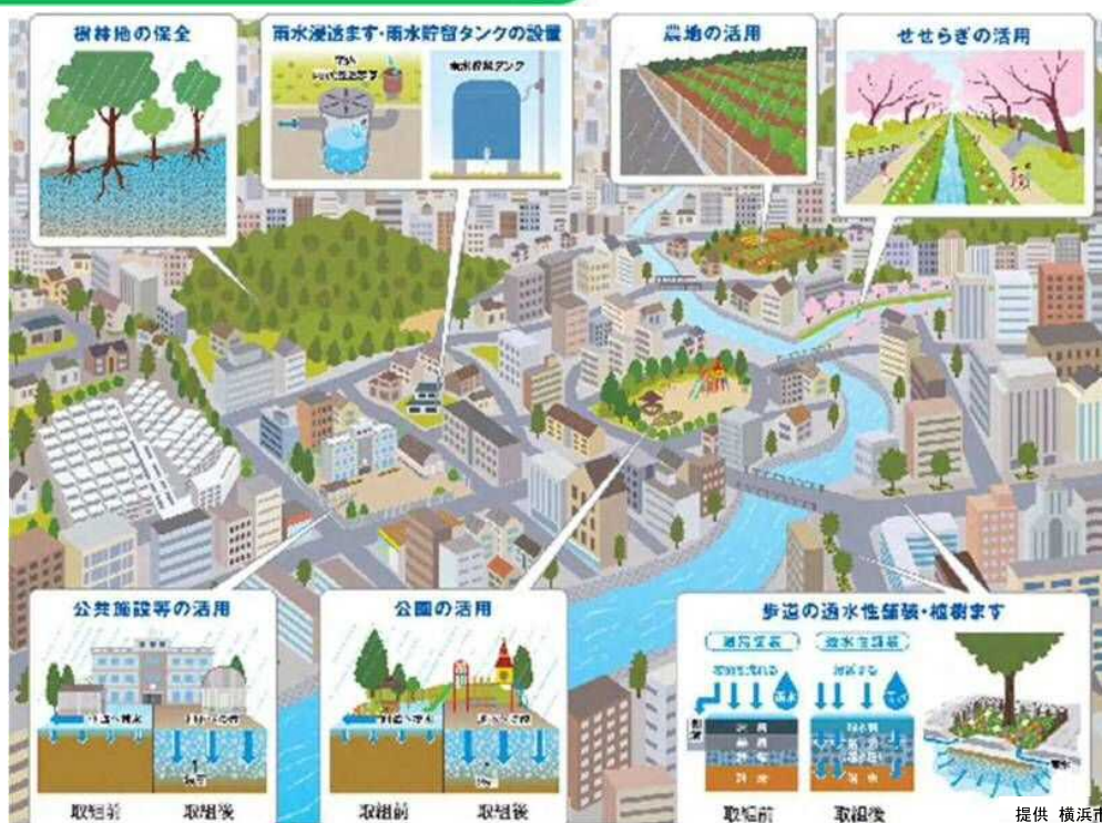
側溝・保水性舗装から入った雨水は、雨水貯留浸透基盤により地表までしみ上がり、蒸発散作用により気温の低減効果が発揮
