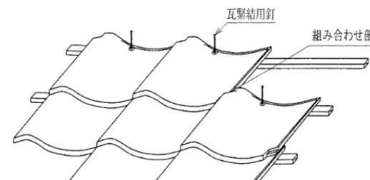
\*\*フックその他これに類する部分によって構造耐力上有効に組み合わせる方法
