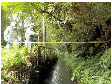
水路周囲の寸法測定
