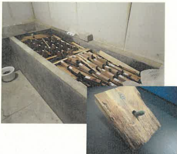
写真5 ファンガスセラーに設置した試験体
