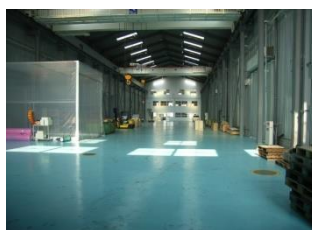
一般組立場 20t・5t親子クレーン2基 吊り治具で30tまで吊り上げ可能
