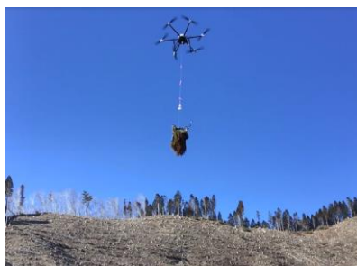
運搬用ドローンによる 苗木運搬
