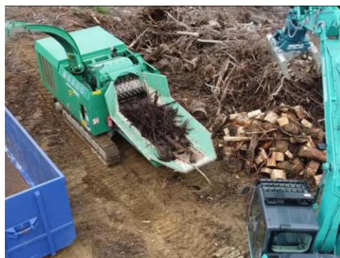
チップパーで破砕される短尺材・枝条等
