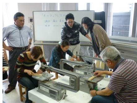
図 2 糸鋸盤による加工状況
