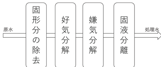
図1 豚房施設排水水の処理過程
