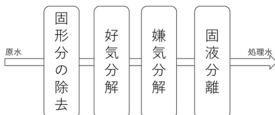
図1 豚房施設排水水の処理過程
