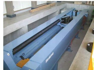
主として実大の柱・梁・桁等土木・建築構造部材の縦引張試験を行う装置。縦引張強さや縦引張ヤング係数の算出に用いる。また、継ぎ手接合部の引張性能試験にも利用できる。
