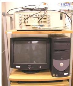
木材及び木質材料の強度試験における微小破壊進展に伴い発生する弾性波（アコースティック・エミッション：AE）の計測および解析に用いる。
