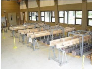
実際の梁桁部材に長期間荷重をかけて、曲げクリープたわみの挙動を調べると同時に構造計算に必要な係数を求めるために用いる。
