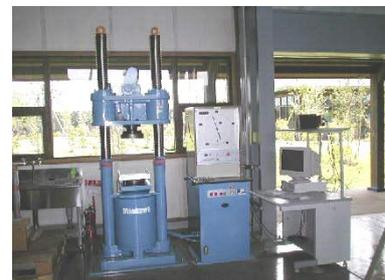
主として実大の柱の短柱縦圧縮試験を行う装置。縦圧縮強さや縦圧縮ヤング係数の算出に用いる。また、接合部のせん断試験にも利用できる。
