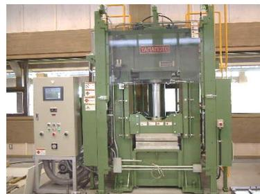
接着剤を塗布した小片や単板等を加熱・圧縮することにより、板状の材料を接着成形する。おもに、低質材、工場廃材、解体材及び樹皮等のこれまで利用度の低かった材料を用いたボード等木質材料の開発に関する研究に用いられる。
