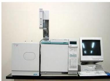
ガスクロマトグラフィーと質量分析計を組み合わせたもの。森林資源からの有用抽出成分の定性・定量に用いる。
