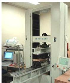
小断面木材の各種強度試験を行い、それぞれの強さやヤング係数などを求めるために用いる。
