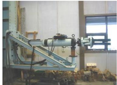
部材や接合部に水平力を加え、変形や曲げ・引張・圧縮・剪断耐力を測定する装置。
