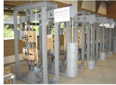
柱-梁接合部、柱-土台接合部などの引張クリープやめりクリープ試験を行い、各種特性を明らかにするとともに構造計算に必要な係数を求めるために用いる。
