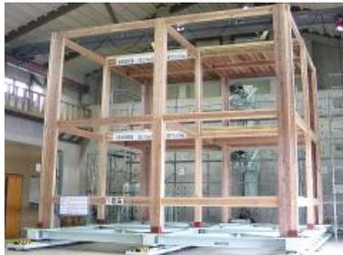
実大の建築物構造体に地震力や風圧力に相当する水平力を加え、変形や構造耐力を測定する試験装置。
