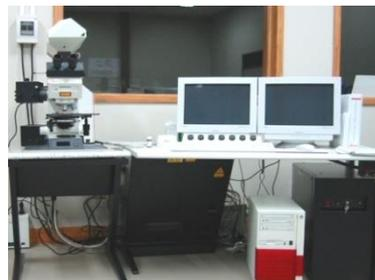
レーザー光線を用いて組織の断層撮影が可能。それらの断層画像を用いてコンピュータ内で合成し、立体的にものを見ることが可能。
