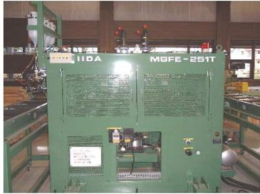
構造用集成材ラミナの機械等級区分及び縦継ぎラミナの保証荷重検査を行うための装置。
