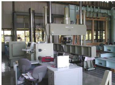
主として実大の柱・梁・桁等の土木・建築構造部材の曲げ試験、座屈試験などを行う装置。それぞれの部材の力学的性質を明らかにする。
