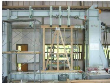
実大の壁体に水平加力し、変形や耐力を測定する装置。壁の剪断耐力から壁倍率を算定することができる。
