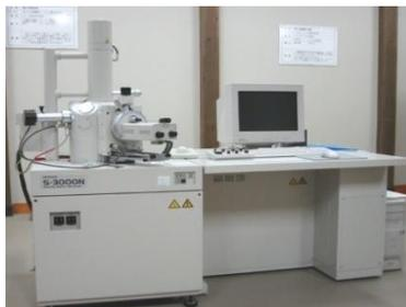
木材の組織構造の研究に用いる。光学顕微鏡に比べ、波長の短い電子線を用いるので、倍率を大きくとれる。また、この電子顕微鏡は走査型なので、対象物を立体的に見ることが可能。
