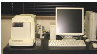
試料の転移温度や反応に伴う発熱量・吸熱量の測定に用いる。
