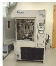
木材の屋外放置（雨、風、太陽光に直接曝す）した場合と同様の状態を短時間（ほぼ 1/20～1/100）で再現できる。
