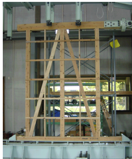
写真2 二つ割り筋かい壁せん断試験
