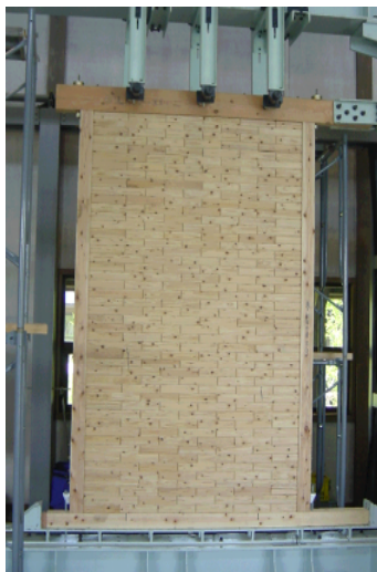
写真1 「つみきブロック」壁せん断試験
