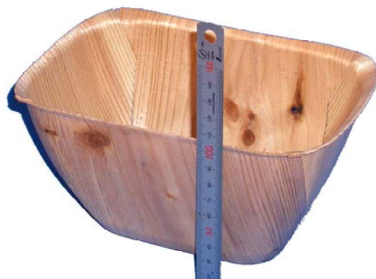
写真1 加圧速度10mm/秒で成型した 木質深底容器
