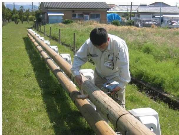
図2 たわみ振動の測定状況
