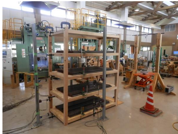
(2) 水平荷重試験風景
