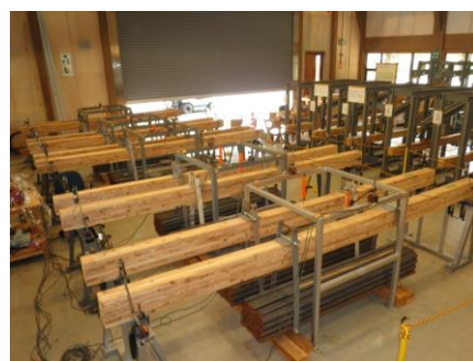
図 1 曲げクリープ試験風景
