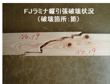
図7 ヒノキ FJ ラミナの縦引張破壊状況
