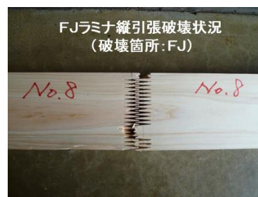
図7 ヒノキ FJ ラミナの縦引張破壊状況
