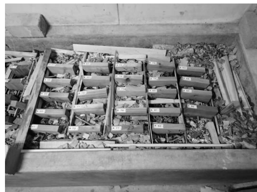
図 2 ファンガスセラー内の試験体設置状況
