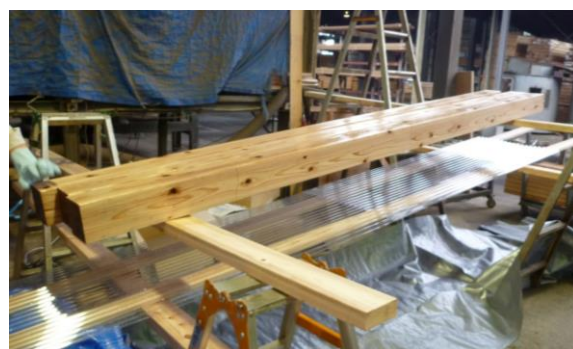
写真2 表面処理後の薬液の滴の除去の様子
