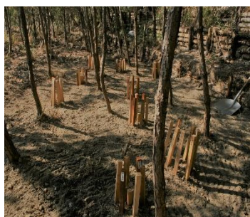
図1 耐蟻性試験の様子 （宮崎試験地）
