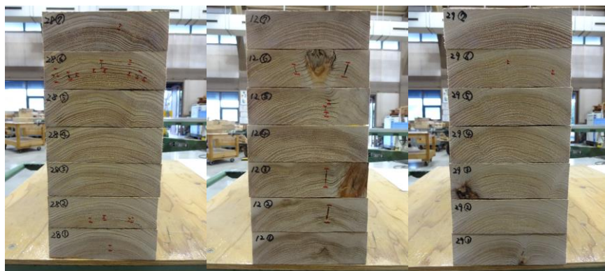
写真2 内部割れの状況
