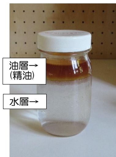
図4 人工乾燥で発生した水蒸気の冷却凝縮液
