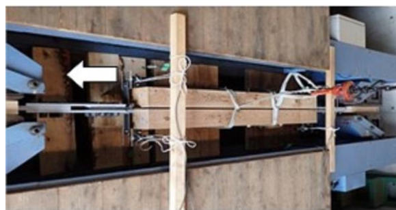
図4 引張試験状況
