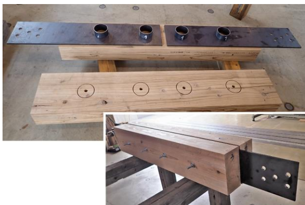
図2 接合金物（試験用に製作）
