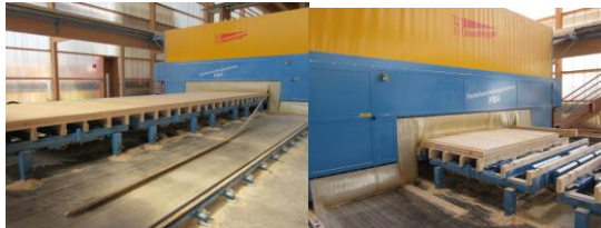
PBA による CLT 加工状況
