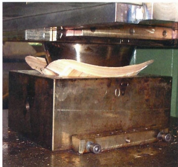
写真1 トレイの熱圧成型
