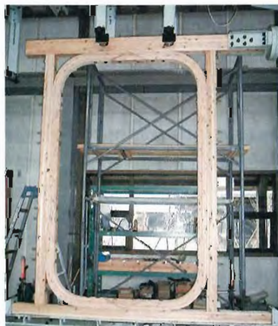
湾曲フレームの実大壁せん断試験
